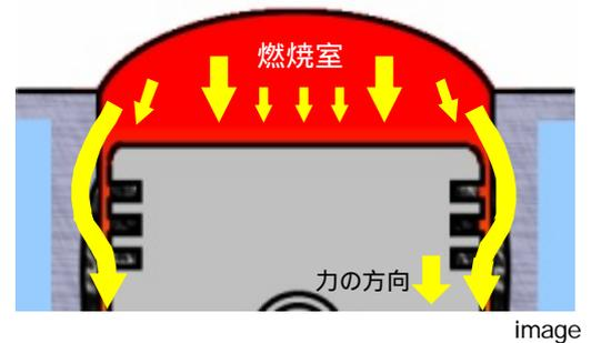
燃焼によってピストンには右の図のような力がかかります。特に冷間時のエンジンの始動などでは、シリンダー壁を摩耗させます。
